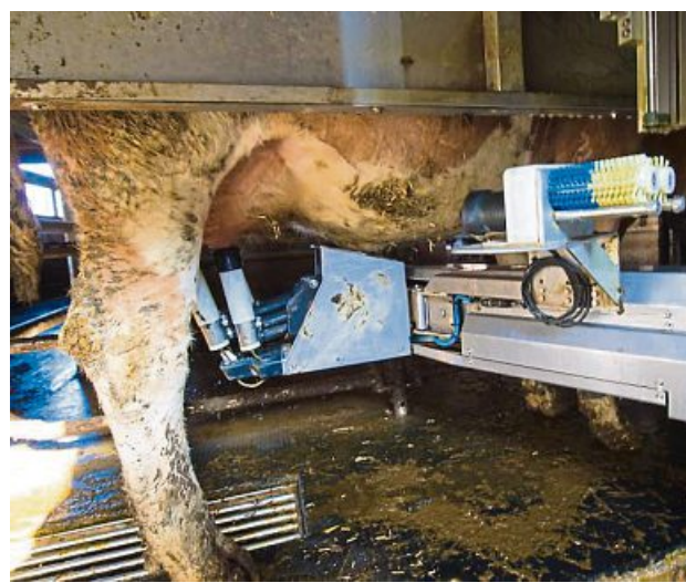
Hightech im Stall: Ein Roboter übernimmt das Melken, er macht sogar das Euter sauber.
